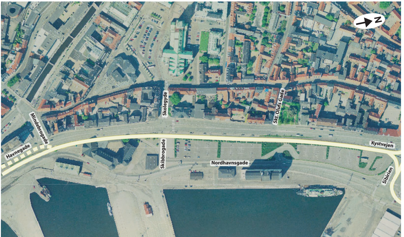
Figur 4.5 Dobbeltsporet tracé langs havneområdet. Letbanetraceet kan også placeres midt i vejprofilen. Skal letbanetraceet fortsætte ad Sønder Allé skal det flettes ud ved Mindebrogade.
