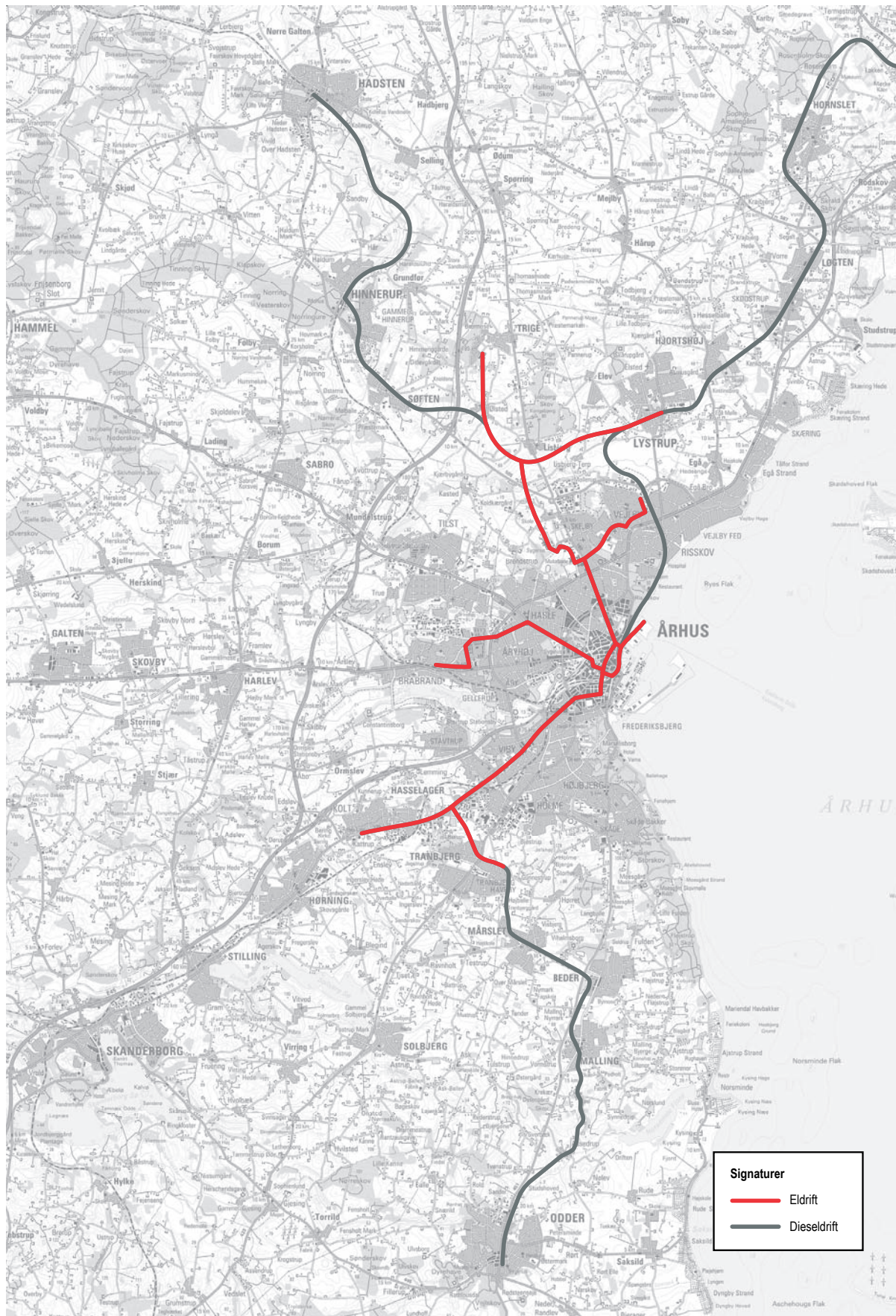
Figur 4.2 Omfang af strækninger der forudsættes elektrificeret.
