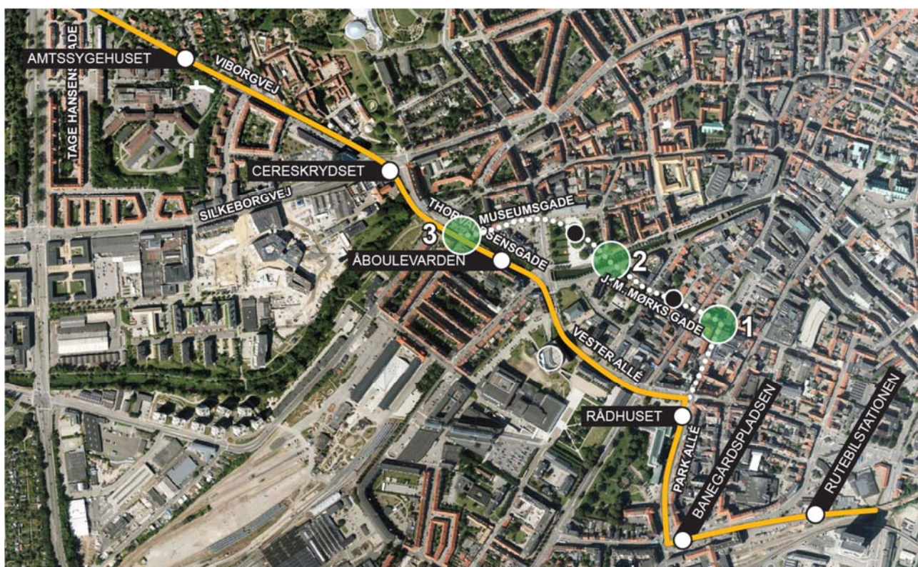
Figur 1 Linjeføring og foreslåede standsningssteder samt fokuspunkter for alternativet via J. M. Mørks Gade.
